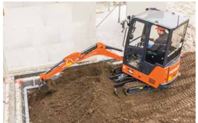
Der minimale Frontschwenkradius ist ideal für Arbeiten unter beengten Platzverhältnissen.
