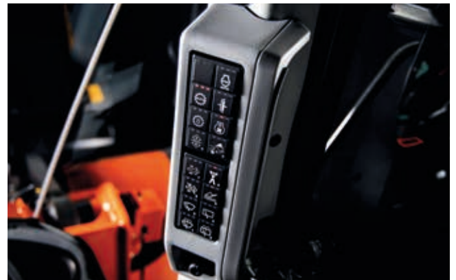
Alle häufig verwendeten Funktionen können Sie übersichtlich mit den Schaltern im seitlichen Bedienfeld erreichen.
