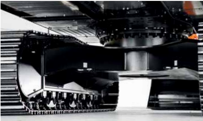
Wytrzymała rama krzyżowa, podwozie i osłony podwozia podnoszą wytrzymałość.
