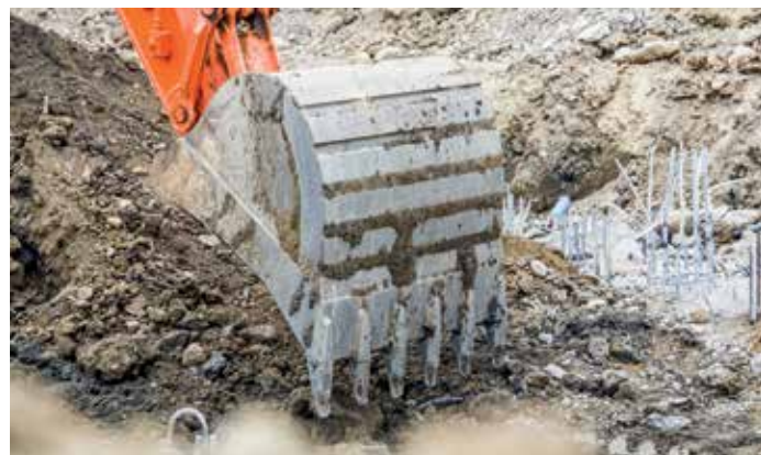
Narzędzia Hitachi do prac ziemnych mają samoostrzące się zęby i niezawodne adaptory, aby zapewnić precyzyjne dopasowanie.
