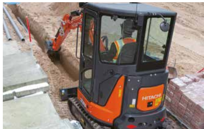
Obrotownica o skróconym tyle sprawia, że koparka ZX33U-6 sprawdza się doskonale w miejscach, gdzie przestrzeń robocza jest ograniczona.
